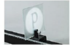
Image, ici « P », modélisée par le segment fléché A'B', réelle, renversée et plus ou moins grande selon la position de l'objet AB
